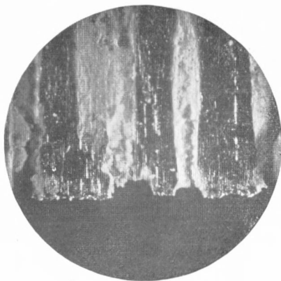
Fig. II. Aluminium-plaat na formatie in NaHCO_3 . Opvallend licht.
